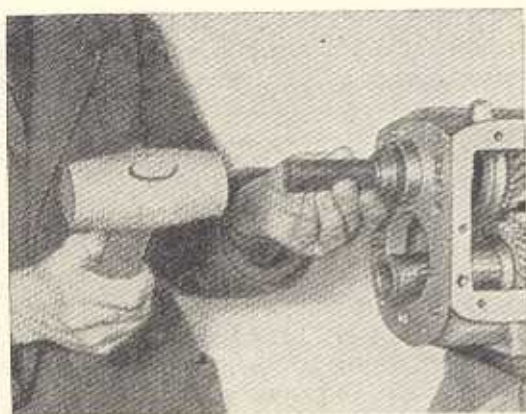
Bild G 65. Einsetzen des Billenkugellagers 6304
