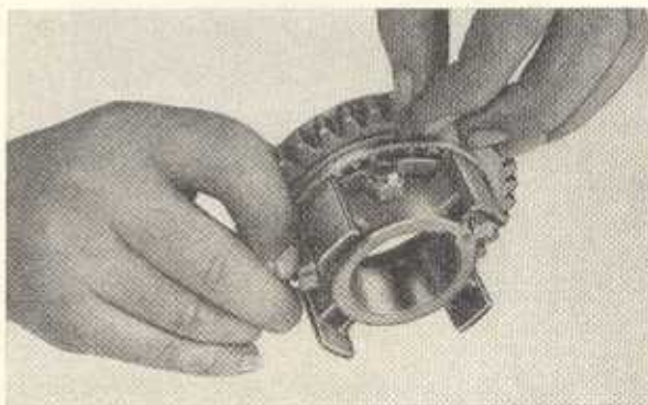
Bilder G 38 und G 39. Einsetzen der Federn und Kugeln in die Sperrstifte mit Einfüllring
