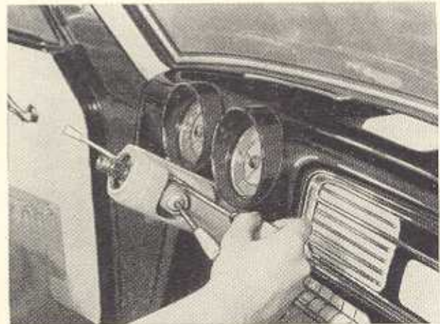
Bild F 6. Abschrauben des Verkleidungsoberteiles
