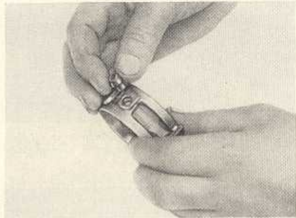
Bild G 57. Einsetzen der Sperrstifte in den Synchronkörper
