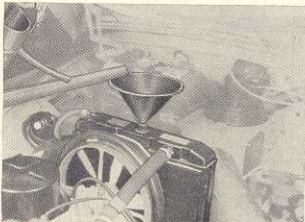
Bild M 79. Einfüllen der Kühlflüssigkeit
