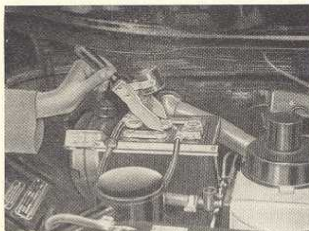
Bild M 68. Überprüfen der Batteriespannung
