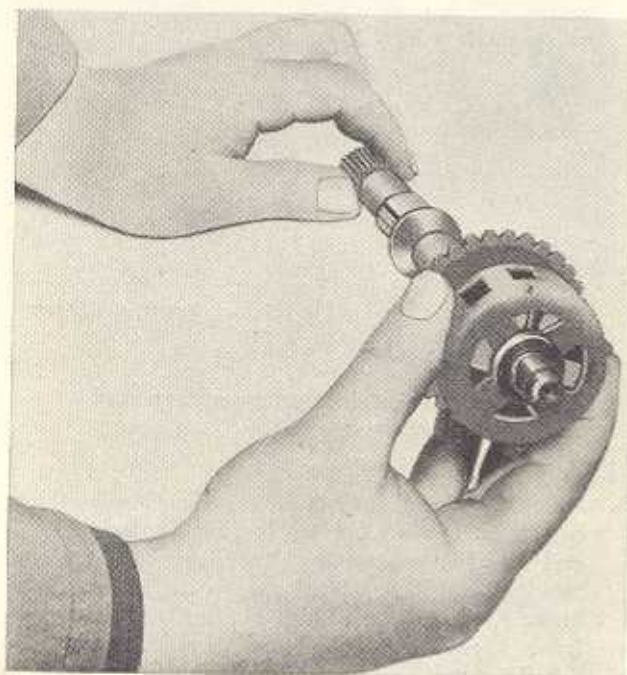
Bild G 113. Käfig mit Drehfeder einsetzen
