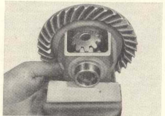
Bild G 45. Einsetzen der Ausgleichkegelräder
