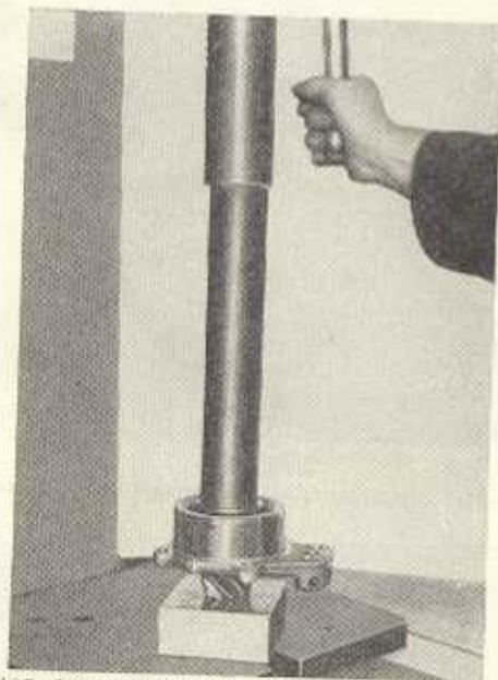
Bild G 105. Schrägkugellager auf die Kegelradwelle pressen
