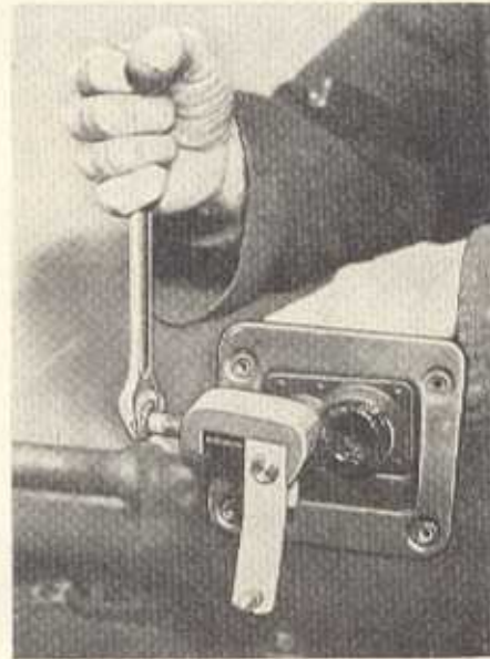
Bild F 5. Herausdrücken der Keilschraube am Schaltrohr
