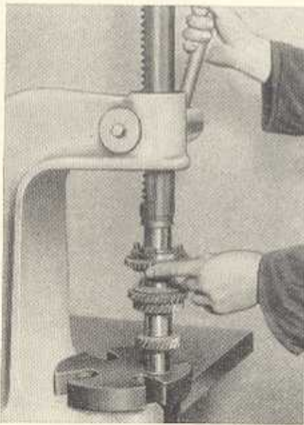
Bild G 43. Zusammenpressen der Vorgelegewelle
