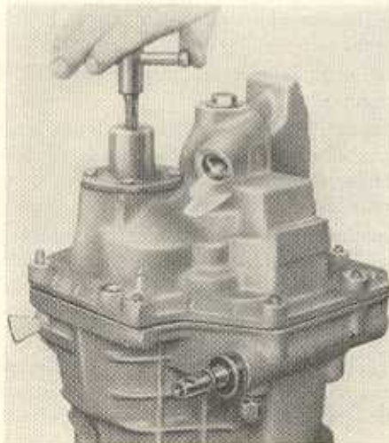
Bild G 93. Hinteres Getriebegehäuse abziehen
