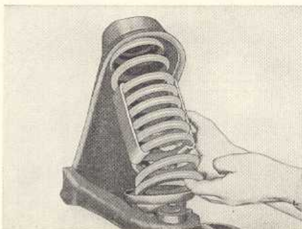
Bild F 33. Herausheben der Vorderfeder
