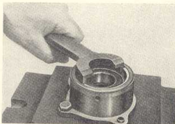
Bild G 35. Lösen der Ringmutter zur Flanschbuchse
