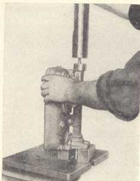
Bild M 29 Herausdrücken des Kugellagers auf der Wasserpumpenseite
