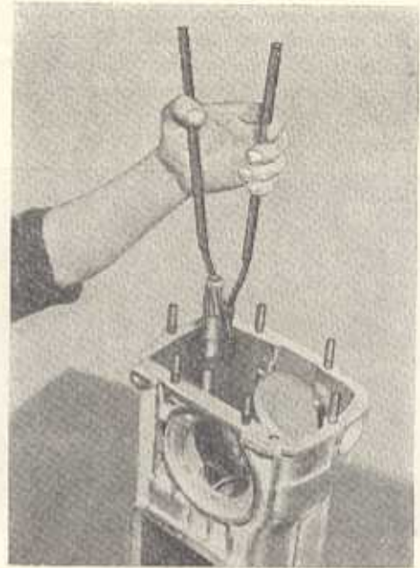
Bild G 25. Abnehmen des Sicherungsringes für mittleres Rillenkugellager der Antriebswelle
